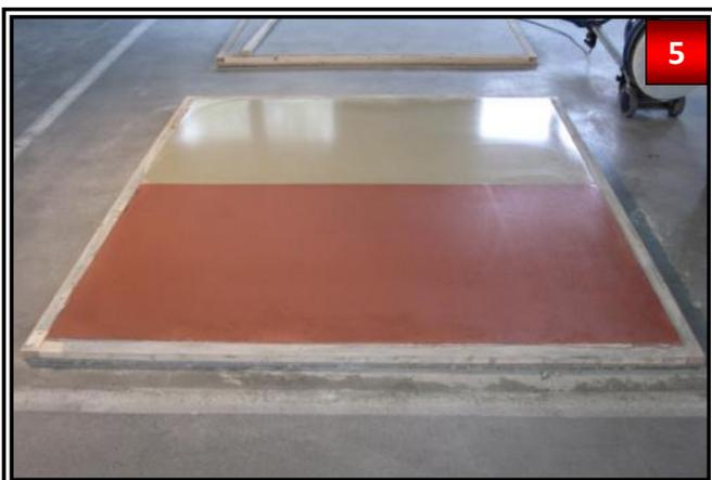
OBTEGO® R-400 zieht weitgehend in den Bodenbelag ein. Ein leicht öliges Schmierfilm bleibt auf der Oberfläche zurück.
